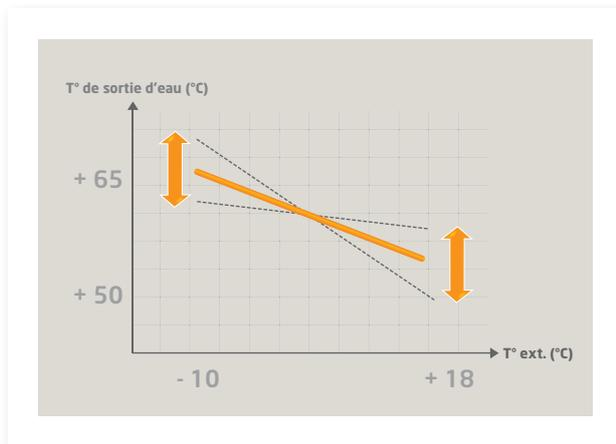
Le système adapte la température de sortie d'eau en fonction de la température extérieure.
